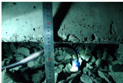
图 9 道砟振动加速度传感器安装
